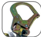
Ganchos metálicos en acero al carbono, cierre y seguro automático, apertura de 18mm en absolvedor y de 60mm en el extremo, con protección galvánica, resistencia mínima a la tensión 23Kn
